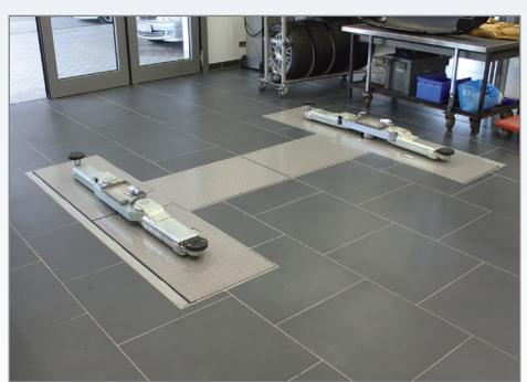
Рамная система с закрывающими пластинами полностью гальванизирована
