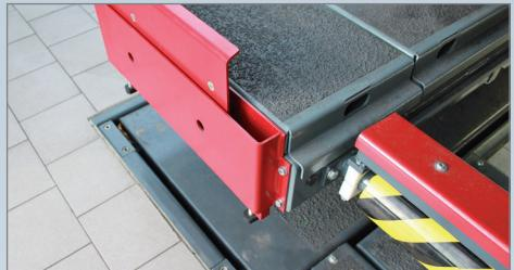
Подъемный пол, расположенный под платформами подъемника, выравнивает поверхность пола, когда подъемник находится над поверхностью.
