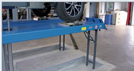
Нивелирование на высоте 1200 мм с использованием откидных опор. В качестве опции предлагаются также телескопические опоры до 1700 мм.
