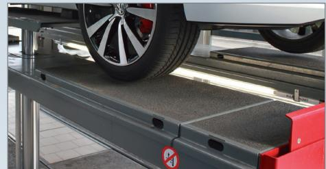
Платформы с выравнивающими пластинами для подъемника второго уровня или комплекта для РУК.
