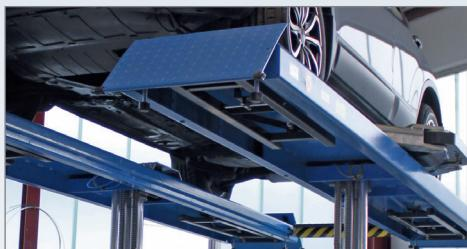
Безопасный и простой способ хранения опор внутри платформ подъемника.
