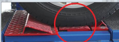
Задняя призма автоматически опускается, все четыре колеса автомобиля находятся на одинаковой высоте
