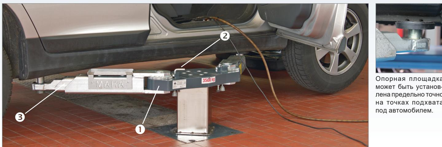
Опорная площадка может быть установлена предельно точно на точках подхвата под автомобилем.
