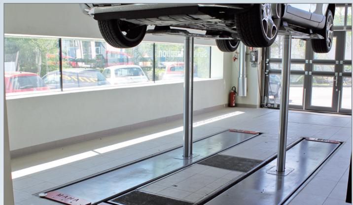
Автомобиль выведен на подъемнике второго уровня с телескопиче- скими рычагами, проездные платформы опущены.
