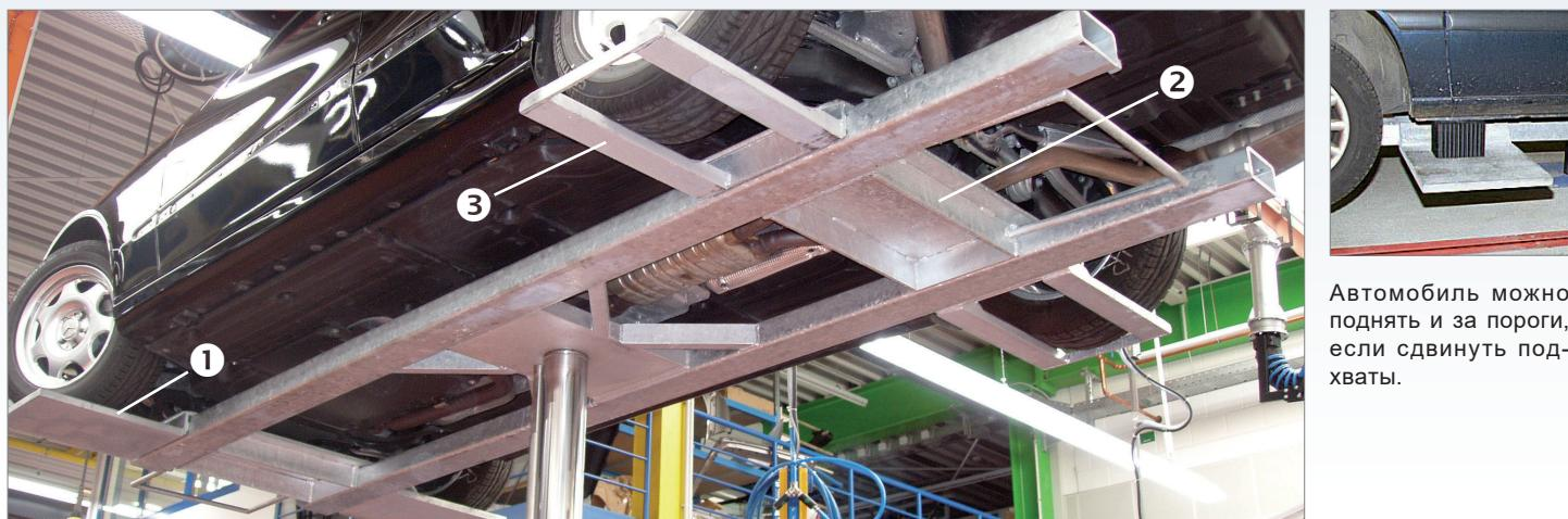
Автомобиль можно поднять и за пороги, если сдвинуть подхваты.
