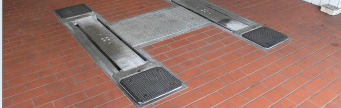
Для простого проезда автомобиля по опорным площадкам.
