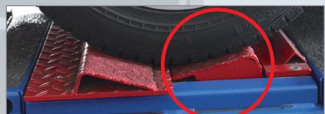
Задняя призма автоматически поднимается для проверки ходовой части автомобиля
