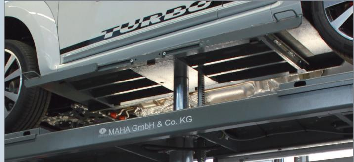
Платформенный подъемник с платформенным подъемником второго уровня, подхват за пороги, грузоподъемность 3,5 т
