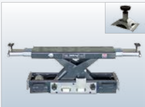
Осевая траверса AL II 2.2 / 2.6 PH, гидропневматическая с эргономичным механизмом управления (рукоятки управления). Регулируемый по высоте центральный суппорт (опция)
