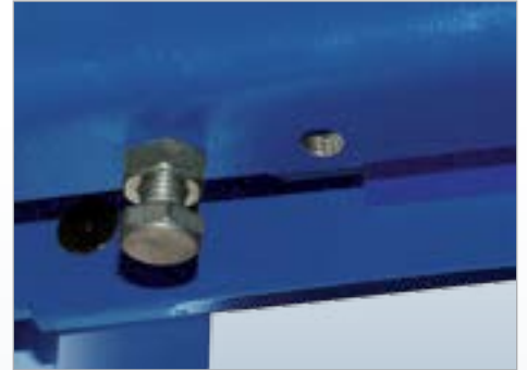
В полностью опущенном положении поперечная балка нивелируется на опорах колонн
