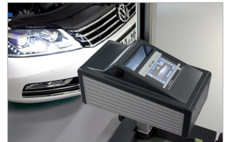
Прибор проверки и регулировки света фар MLT 3000
