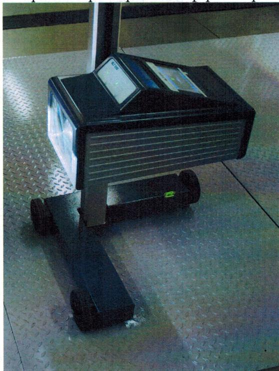
Для предотвращения несанкционированного доступа к внутренним частям приборов для измерений параметров света фар автотранспортных средств MLT 3000 производится пломбирование винтов соединяющих панели корпуса оптической камеры.
