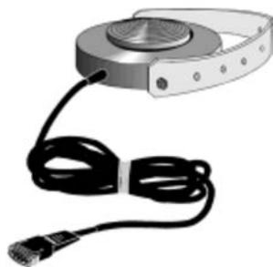
Также возможно измерять текущее давление в гидравлической тормозной системе  $P_m$  при помощи соответствующего датчика давления.
