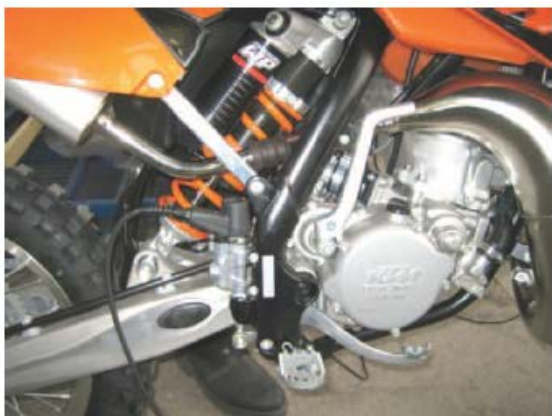
Рис. 6-7....6-14. Варианты установки датчика на мотоциклы и мопеды.
