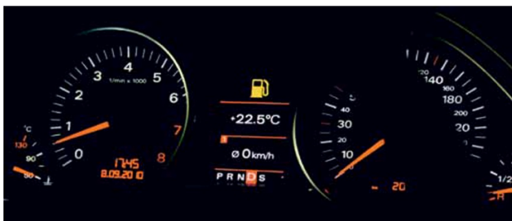
Если это возможно: при любых сомнениях лучше всего перевести АКПП в ручной режим (рис. сверху). В автоматическом режиме (рис. внизу) существует опасность переключения во время измерения мощности.
