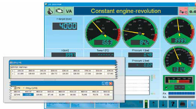
Оптимизация давления наддува: При постоянной частоте вращения 4000 об/мин автомобиль с серийными характеристиками развил 84,2 кВт колесной мощности. После изменения давления наддува мощность достигла величины 90,6 кВт. Величина в Ньютонах на стрелочном указателе на экране показывает тяговое усилие, регистрируемое тензобалкой.
