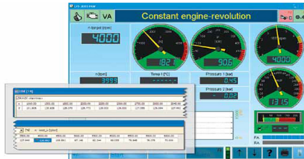
Оптимизация давления наддува: При постоянной частоте вращения 4000 об/мин автомобиль с серийными характеристиками развил 84,2 кВт колесной мощности. После изменения давления наддува мощность достигла величины 90,6 кВт. Величина в Ньютонах на стрелочном указателе на экране показывает тяговое усилие, регистрируемое тензобалкой.
