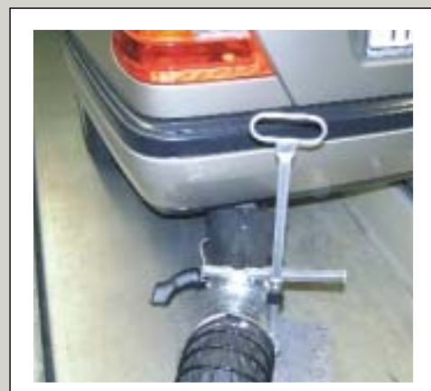
Стационарная экологическая газоприемная насадка, регулируемая по высоте и углу наклона
