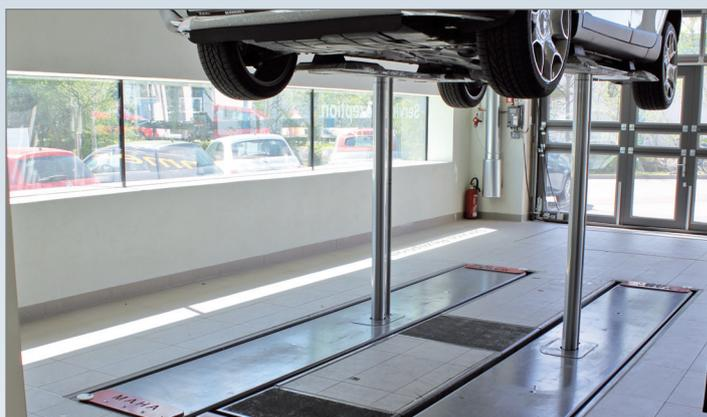
Автомобиль вывешен на подъемнике второго уровня с телескопическими рычагами, проездные платформы опущены.
