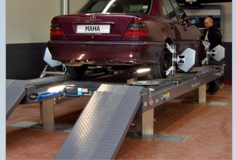
Высокая точность делает возможным использование данного подъемника на постах РУУК
