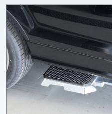
Подвижные опорные площадки с профилированными резиновыми накладками обеспечивают быстрый и безопасный подхват автомобиля под кузов.
