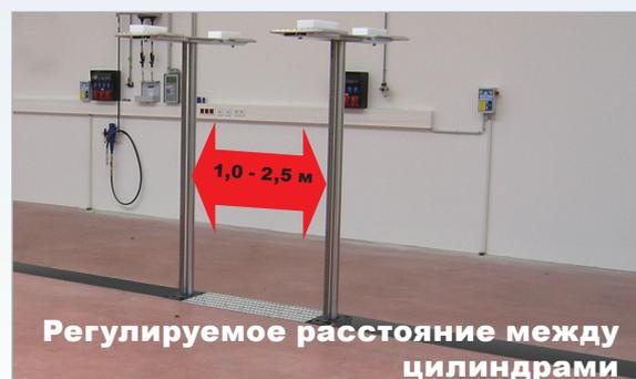
Благодаря системе Megaflex существует возможность изменения расстояния между цилиндрами плунжерных подъемников от 1 до 2,5 м, в результате чего можно использовать любые типы подхватов нашей модульной системы в зависимости от Ваших нужд.
