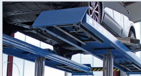
Безопасный и простой способ хранения опор внутри платформ подъемника.
