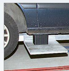
Автомобиль можно поднять и за пороги, если сдвинуть подхваты.
