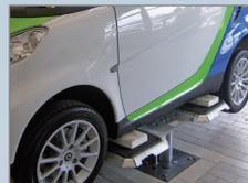
Специальное исполнение платформ с возможностью регулировки по длине от 1150 до 1750 мм. Например, для автомобилей Smart
