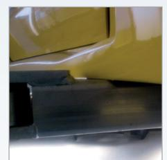
Простое позиционирование опорных площадок благодаря низкопрофильным рычагам.
