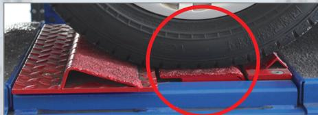
Задняя призма автоматически опускается, все четыре колеса автомобиля находятся на одинаковой высоте
