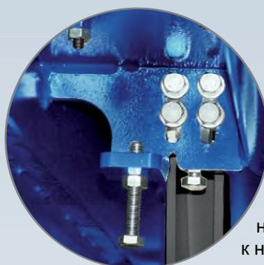
Конструкция опор позволяет регулировать положение платформы независимо по отношению к ножницам.
