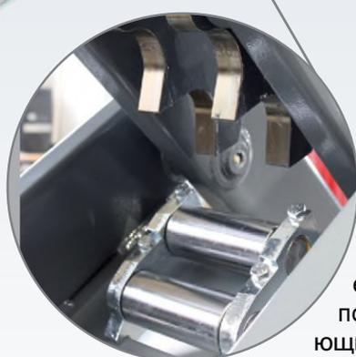
Устройство плавного подъема платформ из нижнего положения снабжено вращающимися роликами, обеспечивающими бесшумную работу и длительную эксплуатацию без частого обслуживания.
