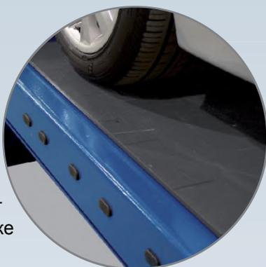
Задние сдвижные площадки пневматически блокируются с пульта управления, обеспечивая тем самым комфорт управления\*
