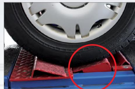
Задняя призма автоматически поднимается для проверки ходовой части автомобиля
