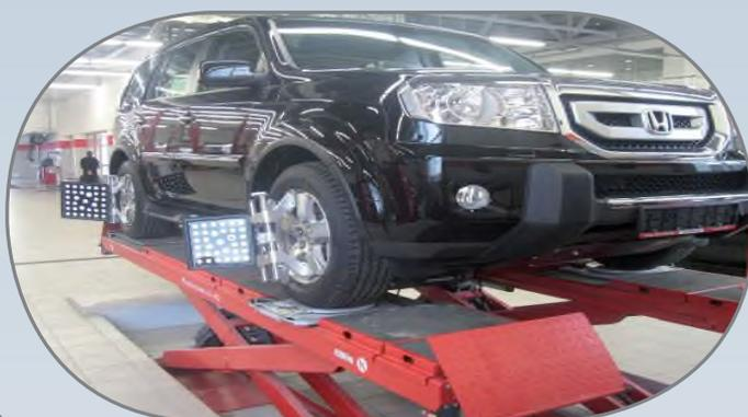
Подъемник DUO CM идеально подходит для работы с современными стендами РУУК, использующими 3D технологии.
