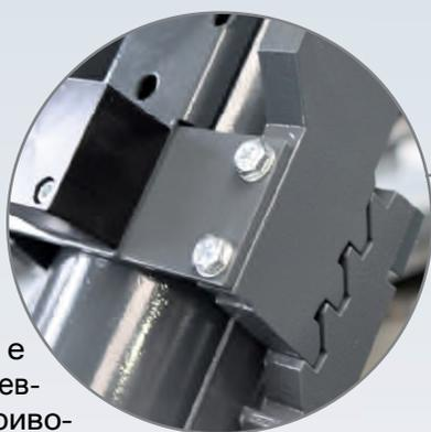
Стопорное устройство с пневматическим приводом предотвращает опускание подъемника при возникновении неисправностей в гидросистеме и обеспечивает механическую постановку подъемника на стопора.
