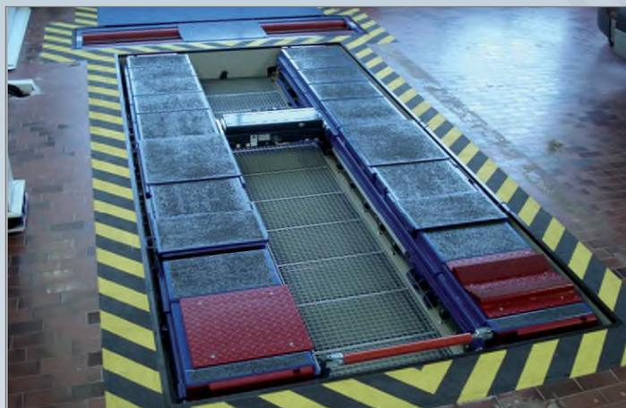
**DUO CM 4.2 U в прямоугольном фундаменте.** На фото изображен подъемник в комплектации для поста активной приемки со следующим дополнительным оснащением: встроенный ножничный подъемник второго уровня с выравнивающими пластинами, осевая траверса, стэнд контроля подвески и рулевого управления PMS 3/X и решетчатый пол.
