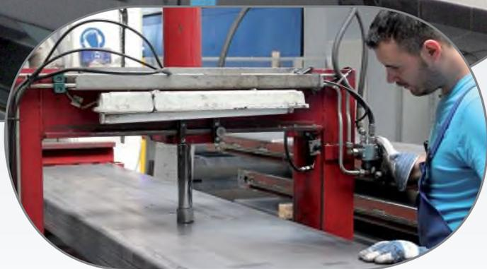
Каждая платформа в процессе производства точно выставляется на стопорах (опция «постановка на стопора»).
