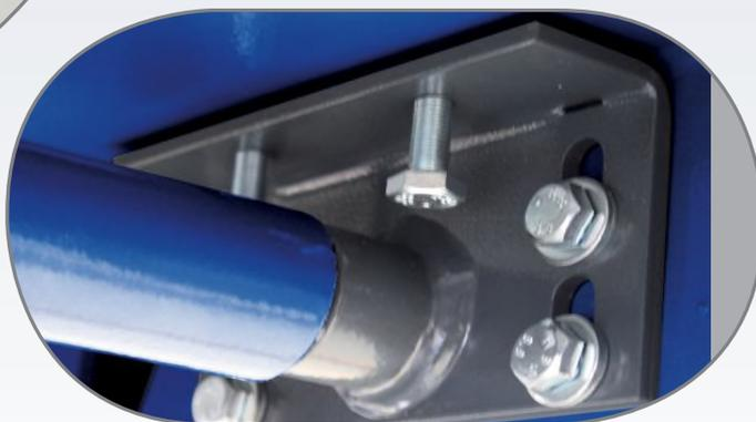
Конструкция опор позволяет регулировать положение платформы независимо по отношению к ножницам.
