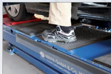
Кроме того, благодаря гранулированному покрытию достигается хороший контакт резиновых подставок с платформами подъемника второго уровня, обеспечивая безопасное вывешивание автомобиля.
