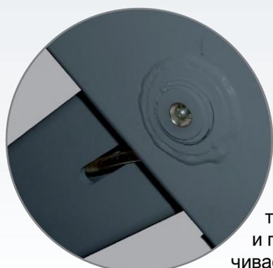
Конструкция подшипника шарнира ножниц с тефлоновым вкладышем и пресс-масленкой обеспечивает высокую надежность и большой срок службы.
