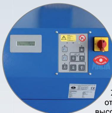
Надежная фольговая клавиатура, ЖК-дисплей для отображения текущих высот платформ подъемника.
