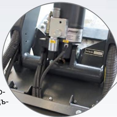
Кабель и гидрошланги проведены внутри ножниц подъемника.
