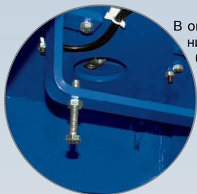
В опущенном положении подъемника положение платформ может быть отрегулировано дополнительно
