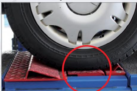
Задняя призма автоматически опускается, все четыре колеса автомобиля находятся на одинаковой высоте
