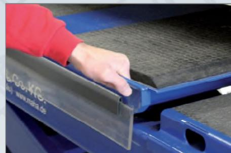
Платформы и выдвижные удлинители платформ имеют **гранулированное покрытие в стандартной комплектации**, что обеспечивает отличное сцепление колес и обуви с поверхностью подъемника.
