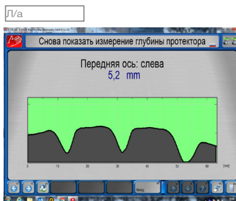
Измерение остаточной глубины протектора шины ТМ 1000 автоматически измеряет остаточную глубину протектора по всей окружности и ширине шины.
