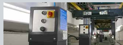
Электрогидравлический привод Две кнопки управления для подъема / спуска. Цикл спуска можно регулировать по скорости
