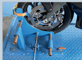
Механическое зажимное устройство для фиксации колеса
