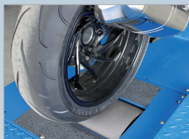
Инерционный монороликовый стенд обеспечивает оптимальное сцепление и снижает нагрев шины
