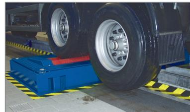
**Подъемный роликовый агрегат**
