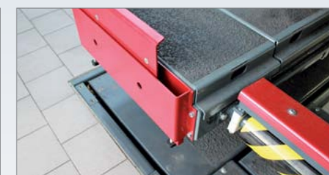
Der Bodenausgleich unter der Fahrfläche ist ein zweiter Boden, der die Fläche unter der Hebebühne wieder ebnet.
