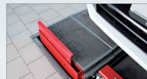
Der Bodenausgleich unter der Fahrfläche ist ein zweiter Boden, der die Fläche unter der Hebebühne wieder ebnet.
