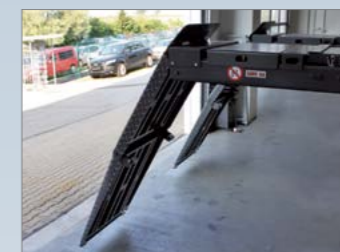
Klapp-Auffahrrampe bei hohen Fahrflächen oder geringen Auffahrwinkel
