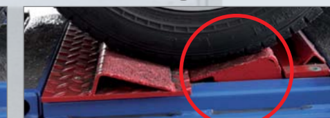
Hintere Prismenhälfte wird automatisch zur Achsprüfung ausgefahren
