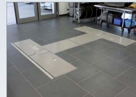
Vollständig abgedeckte Schwenkarmaufnahme Überfahrbar mit einer Radlast von 2t
