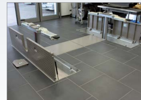
Rahmensystem mit Abdeckplatten, komplett feuerverzinkt
