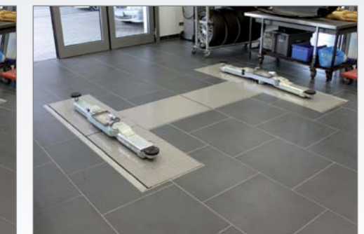
Die Hebebühne kann mit geschlossener Abdeckung als Standard-Hebebühne genutzt werden
