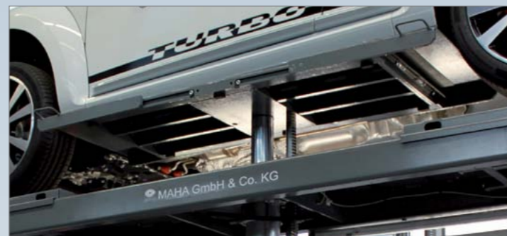
Fahrflächen Hebebühnen mit Plattformradfreiheber, Schwelleraufnahme Traglast 3,5 t
