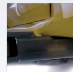
Leichtes positionieren der Tragteller-Aufnahmen durch geringe Bauhöhe der Schwenkarme.
