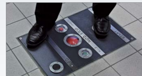
Steuerung im Boden eingelassen
