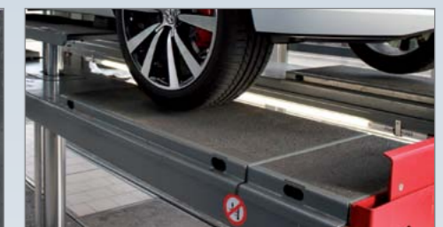
Fahrflächen mit Ausgleichplatten zum Nivellieren an den Radfreiheber oder an die Achsvermessung.
