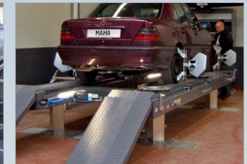
Hohe Genauigkeit als Achsmesshebebühne
