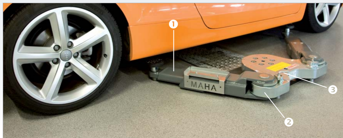
Leichtes positionieren der Tragteller-Aufnahmen durch geringe Bauhöhe der Schwenkarme.
