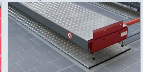
Aluminiumbeplante Fahrflächen mit Abkantung für besseren Wasserablauf
