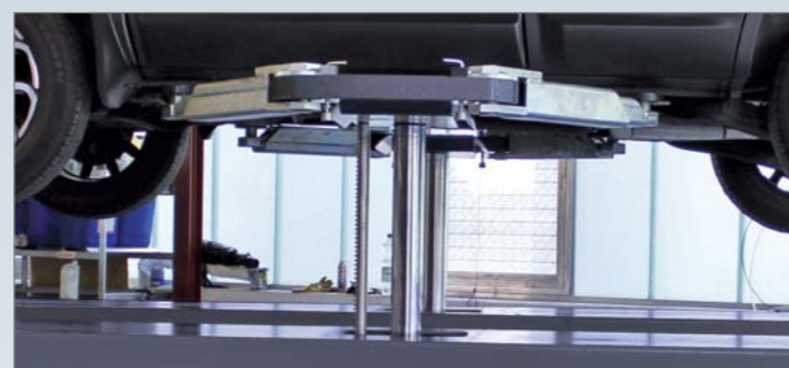
Fahrflächen Hebebühnen mit Schwenkarmradfreiheber, Rahmen- und Schwelleraufnahme Traglast 3,2 t; 3,5 t oder 5,0 t
