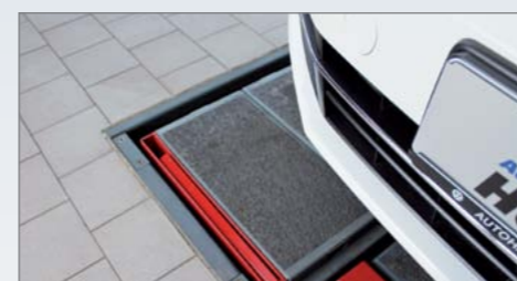
Der Bodenausgleich unter der Fahrfläche ist ein zweiter Boden, der die Fläche unter der Hebebühne wieder ebnet.
