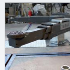
Unterschwenkhöhe am Aufnahmeteller von 117 mm
