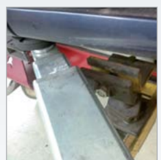
Einfaches Platzieren der Richtbankbrücke. Durch die rechtwinkligen Fahrzeugaufnahmen entsteht eine hohe Bewegungsfreiheit unter dem Fahrzeug und den Richtbankaufnahmen.
