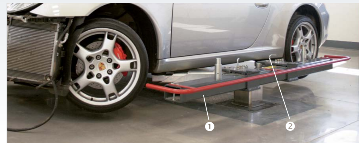
Einfaches Platzieren der Richtbankbrücke. Durch die rechtwinkligen Fahrzeugaufnahmen entsteht eine hohe Bewegungsfreiheit unter dem Fahrzeug und den Richtbankaufnahmen.
