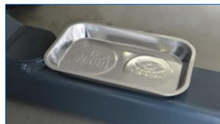
Магнитный лоток для гаек крепления колес.
