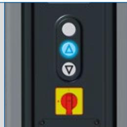
Достигнута нижняя конечная позиция или совершен наезд на препятствие. Возможен только подъем. Синий цветовой сигнал клавиши подъема.
