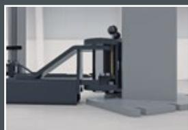
Опорные рычаги разворачиваются непосредственно над полом, что обеспечивает очень малую высоту опорных дисков.
