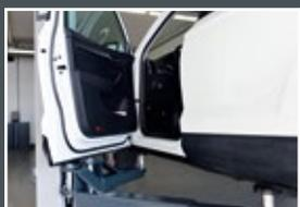
Увеличенный угол открывания двери для комфортного выхода из автомобиля за счет стоек, развернутых на 45° (тип "А").
