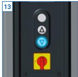
13 Достигнута верхняя конечная позиция или сработал световой барьер. Возможен только спуск. Синий цветовой сигнал клавиши спуска.
