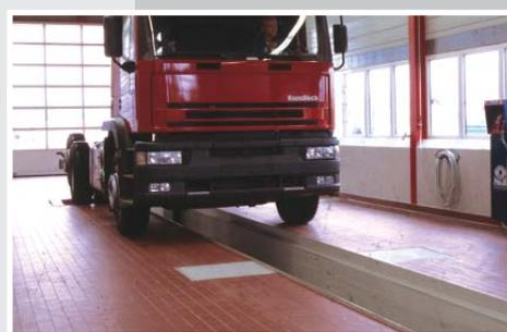
▶ Две подвижные гидравлические площадки имитируют все возможные нагрузки, испытываемые подвеской и рулевым управлением в процессе движения автомобиля
