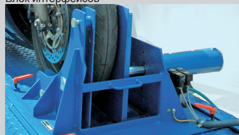
Пневматическое зажимное устройство для мотоциклов (Опция)
