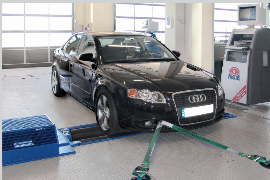
Фиксация автомобиля удерживающими ремнями
