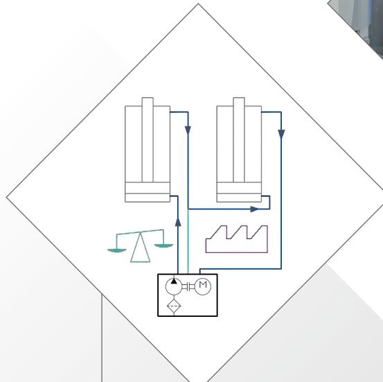
Система master-slave гарантирует надежную синхронизацию стоек подъемника при подъеме и спуске без дополнительного контроля.
