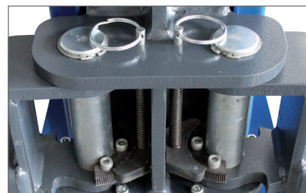
Автоматическая блокировка и ручная разблокировка опорных рычагов
