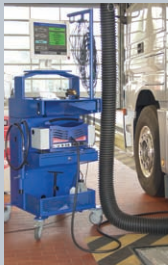
Измерение дымности грузового автомобиля
