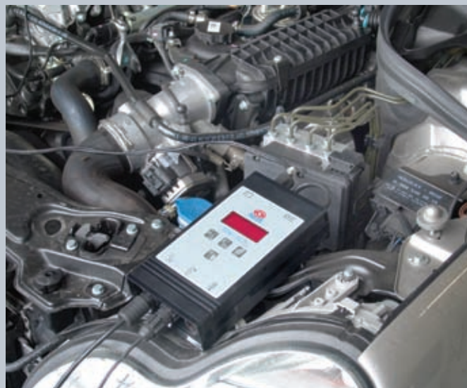
RPM VC 2, измерение частоты вращения вибросенсором или по пульсации бортового напряжения
