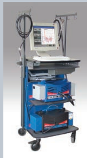
Газоаналитическая стойка (вместе с газоанализатором MGT 5)
