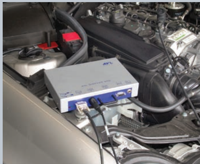
DISPEED 490, пример измерения частоты вращения при помощи магнитного комбисенсора
