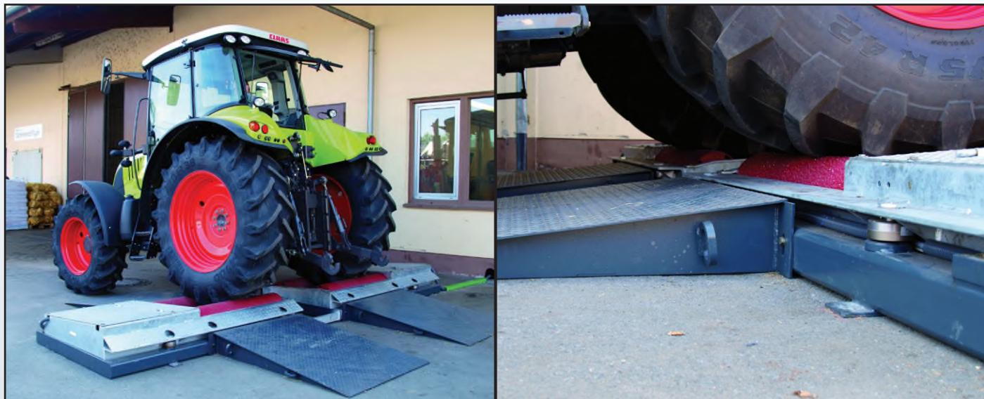
Роликовые тормозные стенды серии MBT 6000 разработаны специально для диагностики тормозных систем тракторов. Расстояние между осями диагностических роликов увеличено, чтобы обеспечить правильный захват колеса во время диагностирования и, соответственно, верные и точные результаты испытания.
