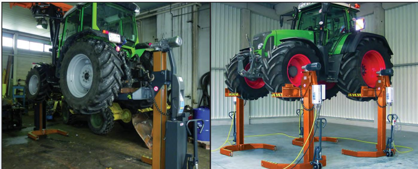
Подкатные подъемники MAXA для тракторов предназначены для обслуживания техники с колёсами большого диаметра.
