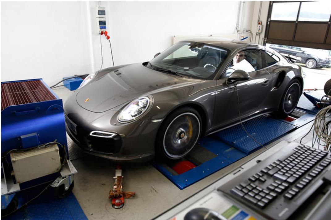
В чем же различия? В twin-roller стенде колеса автомобиля вращаются на двух роликах, на поддерживающем и на тормозном ролике, их диаметр меньше, чем диаметр у монороликового стенда, который часто достигает величины до 1 метра. Какие же недостатки у twin-roller стенда?
