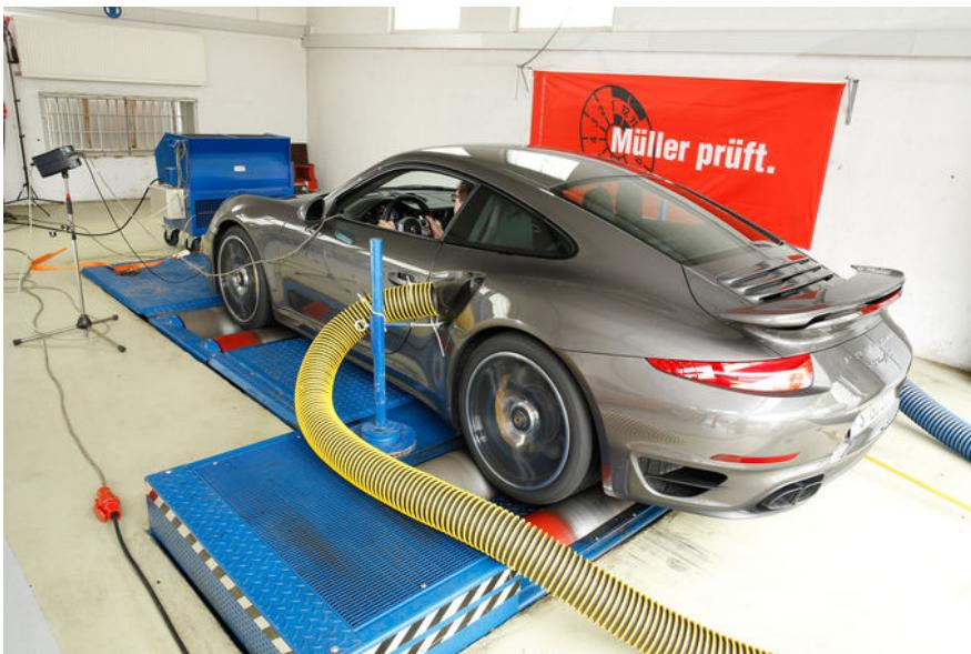
«При перегреве увеличивается температура впускаемого воздуха и электроника сразу же снижает мощность», - объясняет Пляйнис. Удивительно: иногда все показатели двигателя совпадают, а результат измерений нет, что как раз и происходит из-за слишком высоких температур для блока управления коробкой передач. И, как следствие, бортовой компьютер понижает и мощность. «Часто в автомобилях с V-образными двигателями коробка передач расположена так, что ее нагрев еще более ощутим», - говорит Пляйнис.
