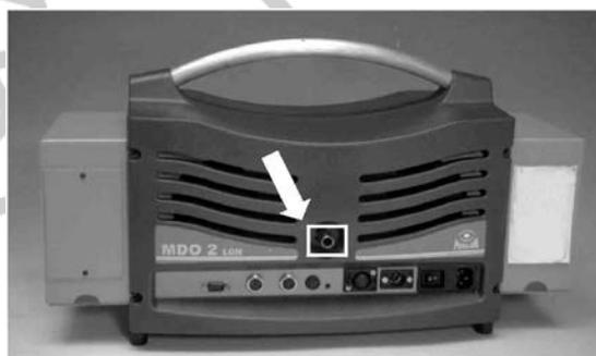
3. Соедините базовый прибор специальным соединительным кабелем с ПЕРСОНАЛЬНЫМ КОМПЬЮТЕРОМ.
