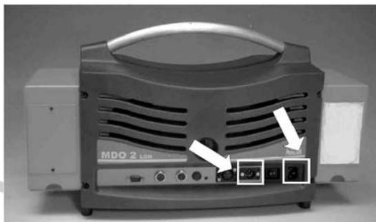
2. Присоедините измерительный зонд отработавшего газа к базовому прибору и закрепите измерительный зонд на выпускной трубе транспортного средства.
