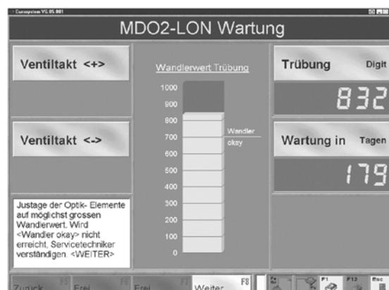
10 Если настройка не в порядке, то возможно элементы оптики не достаточно основательно очищены или ошибочно установлены. В этом случае легко поворачивайте рукой излучающий и приемный элементы в местах их установки, до появления оптимального результата на экране. Чем больше будет значение преобразователя, тем лучше.
