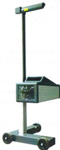
Общий вид приборов для измерений параметров света фар автотранспортных средств MLT 1000
