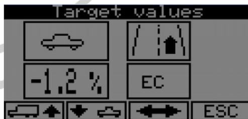
Если один раз долго нажать кнопку <F1> или <F2>, то произойдет быстрое переключение между заданными угламиклонения светового пучка для грузовиков и легковых автомобилей.
