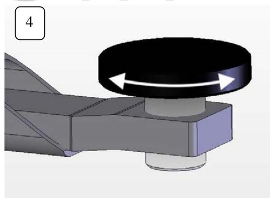
1. Полностью опустите подъемник и поверните рычаги для обеспечения максимальной ширины заезда, как показано на рисунке
