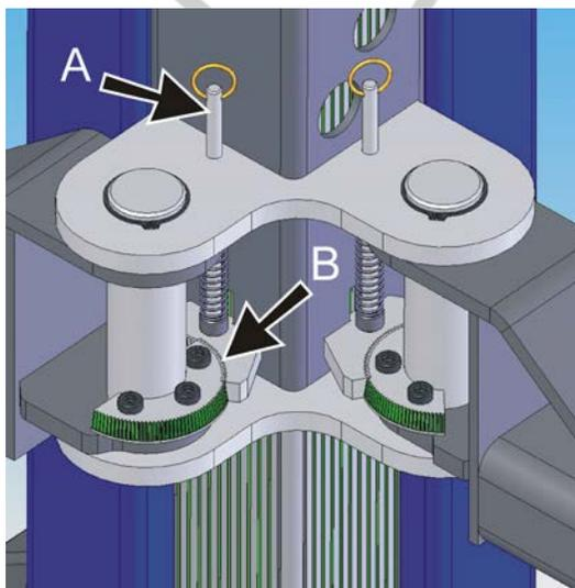
Каждый опорный рычаг блокируется, разблокировка происходит автоматически в нижнем положении каретки
