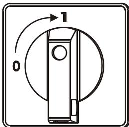
Главный выключатель в позиции "0": подъемник обесточен
