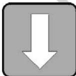
Как только нажата одна из кнопок, подъемник движется до того момента, пока не будет отпущена кнопка или не будет достигнут ограничитель.
